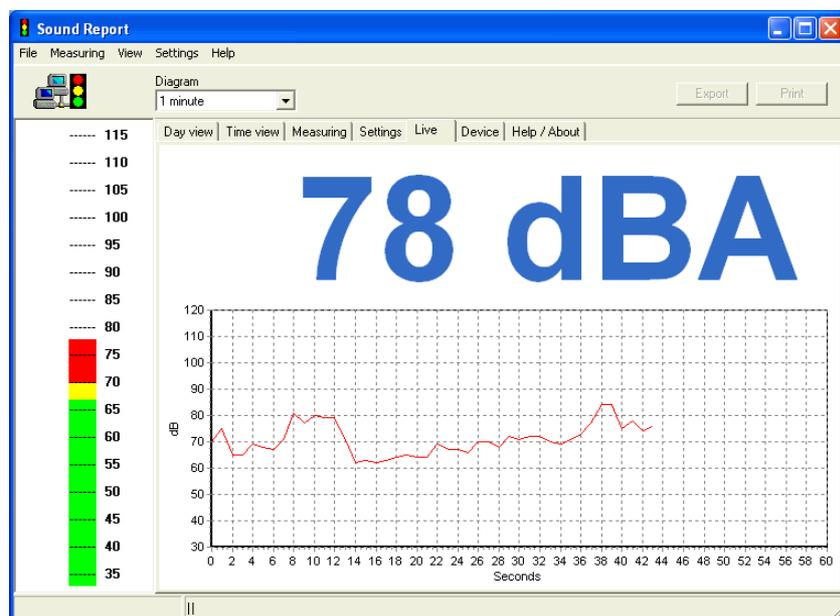
I menylinjen kan diagrammets tidsakse velges fra 1, 5, 10, 30 min resp. 1 eller 12 h opp til 1 dag. Lydnivået begynner som en rød linje, fra venstre til høyre. Når diagrammets tidsakse er fylt, begynner diagrammet å "rulle mot venstre" slik at man alltid ser lydnivået i den sist valgte tidsperioden.
