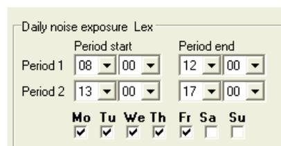
**Vær klar over at beregningsinnstillingene ikke påvirker måledatafilens innhold.** Det innebærer at ubegrenset antall gjentatte beregninger og analyser kan gjennomføres og skrives ut for ulike alternativer i løpet av døgnet.
